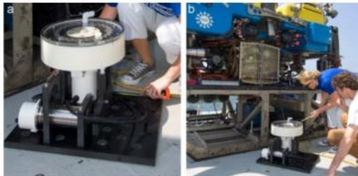
図1. SUPRサンプラーはWHOIで設計・製作され、光学センサー互換、マルチサンプルフィルターヘッドがMcLane Research Laboratories社の高い流量レートで濾過するシステムにインターフェイスされています。ROV搭載に組込まれる際、SUPRシステム (a) はROV Jason(b)に科学機器ペイロードとしてどの場所でもフィットできるように十分小型です。
