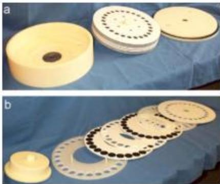
図3. a)ハウジング内に封入されるフィルターロゼットで構成されるSUPRサンプラーヘッド
