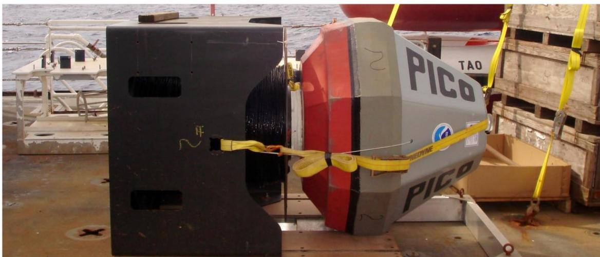
Fig. 1. 投入準備完了状態の PICO 係留系
