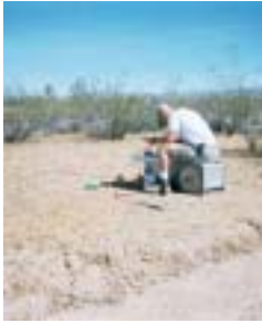
ネバダ州南部におけるCSAMT法データ取得風景。1 Kmを超える深度の高い方位分解能でCSAMTデータ取得されました。
